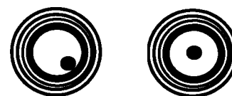
НЕПРАВИЛЬНО ПРАВИЛЬНО Рисунок 5.1 – Установка уровня
